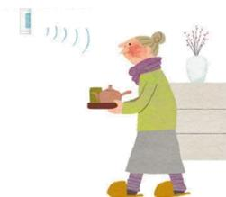
廊下やトイレ前など、生活動線上に設置したセンサーが、一定時間以上、動きが確認できない場合、セコムに通報します。
